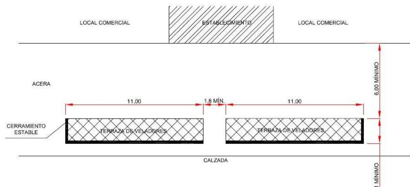
EJEMPLO TIPO DE TERRAZA CON ESTRUCTURA FIJA EN ACERA CONVENCIONAL TOTAL TERRAZA FREnte A FACHADA
