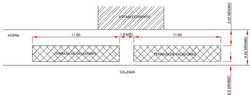
En aquellas intersecciones en las que existan pasos peatonales en ambos lados de la esquina, el espacio entre la fachada y el mobiliario de la terraza será de al menos 3 metros en la zona situada entre ambos cruces de calzada.
